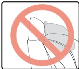
d'appuie-tête du siège pour enfant plus haut que l'appui-tête du véhicule. Cela pourrait compromettre la sécurité du siège pour enfant. Si l'appui-tête du véhicule cause une interférence avec l'appui-tête du siège pour enfant, levez ou enlevez l'appui-tête du véhicule. Si vous ne pouvez enlever l'appui-tête du véhicule, redressez le siège pour enfant en position verticale ou choisissez une autre place assise pour installer le siège pour enfant.
