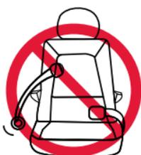
Ceinture sous-abdominale avec une boucle cousue dont le rétracteur ne se verrouille qu'en cas d'arrêt soudain.
